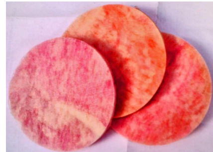
Stanzteile mit einem Durchmesser von 97 mm aus Glasfasermedium der Filterklasse F7
